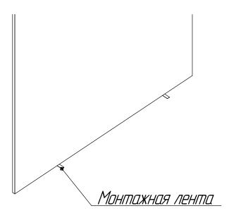
б) Оденьте на низ стекла (1) монтажный уплотнитель. После окончательной сборки изделия, не извлекая уплотнитель, нанесите герметик.
