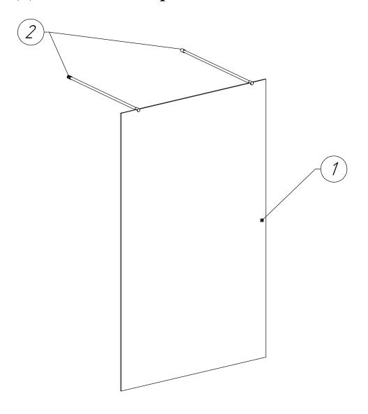
Обратите внимание, что максимальное расстояние установки перегородки от стены до наружней кромки стекла составляет 1200 мм.
